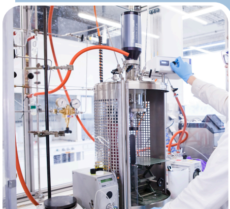
Réacteur pour la production d'élastomères avancés avec des catalyseurs développés chez CP2M
